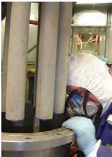
กระบวนการประเมินอันตรายเบื้องต้นในพื้นที่ทำงานนาโน (ภาพแสดงเครื่องมือที่ใช้และแหล่งกำเนิดอนุภาคนาโน)
