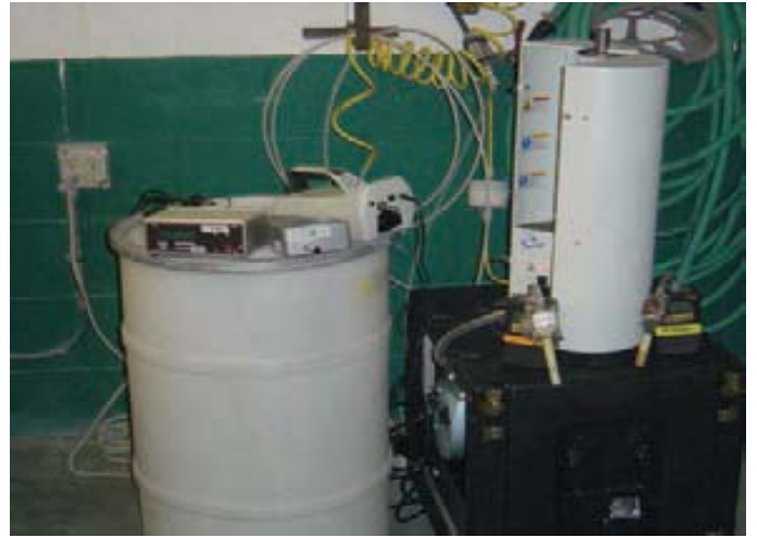
ตัวอย่างเครื่องมือใช้ในการวัดอัตราการสัมผัสอนุภาคนาโนของผู้ปฏิบัติงาน รวมถึงการตรวจนับจำนวนและวัดขนาดของอนุภาคนาโนตามเวลาจริง (Real-Time)
