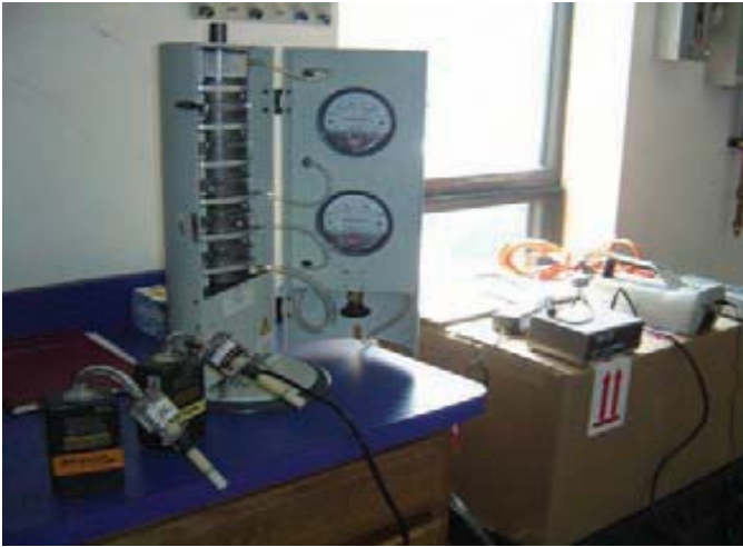
ตัวอย่างเครื่องมือใช้ในการวัดอัตราการสัมผัสอนุภาคนาโนของผู้ปฏิบัติงาน รวมถึงการตรวจนับจำนวนและวัดขนาดของอนุภาคนาโนตามเวลาจริง (Real-Time)
