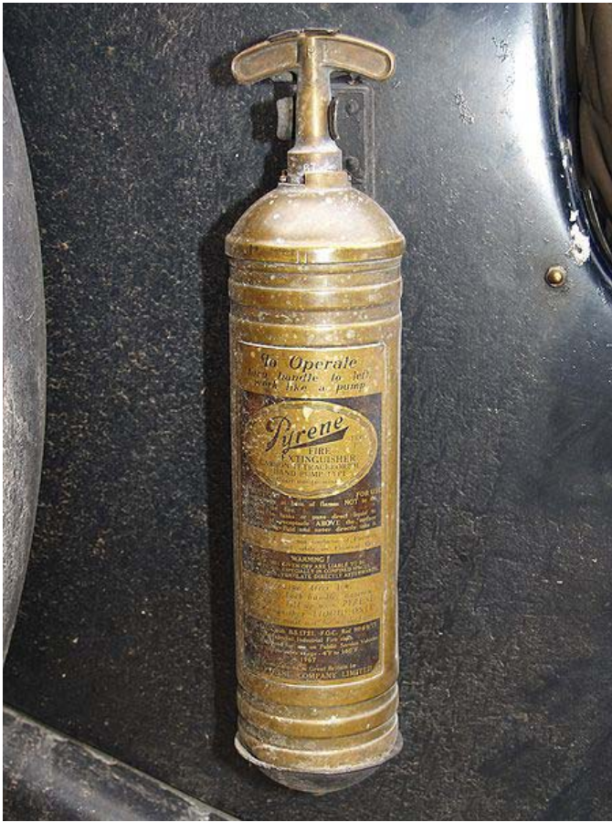
เครื่องดับเพลิงคาร์บอนไดออกไซด์ถังทำด้วยทองเหลืองของไฟริน
