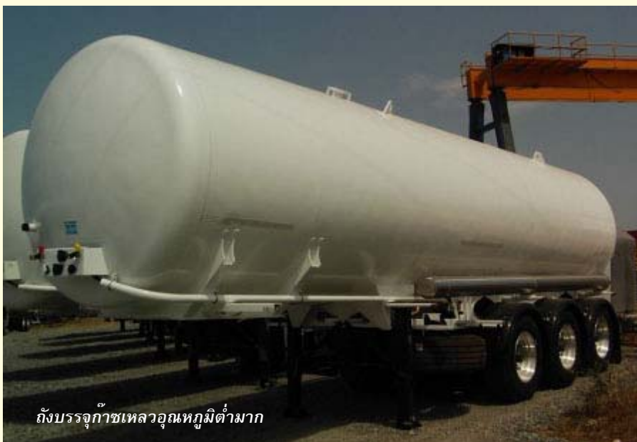
ถังบรรจุก๊าซเหลวอัดความดัน
