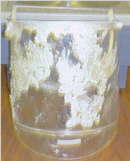
ภาพ C : หน้ากากที่ถูกอะลูมิเนียมหลอมเหลวระเบิดใส่ซึ่งช่วยลดความรุนแรงของอุบัติเหตุที่เกิดขึ้นกับพนักงานได้อย่างมาก
