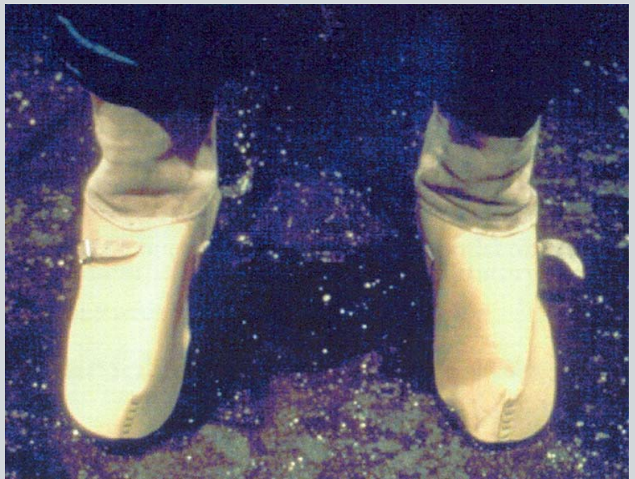
ภาพ B : ปกคลุมปิดเท้าเพื่อป้องกันอะลูมิเนียมกระเด็นเข้าไปในรองเท้า
