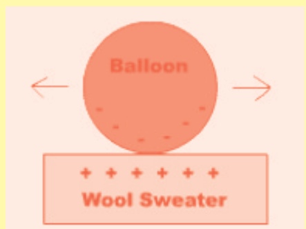
ภาพแสดงการเสียดสีระหว่างวัตถุ 2 ชนิดที่ต่างกันทำให้เกิดไฟฟ้าสถิต
